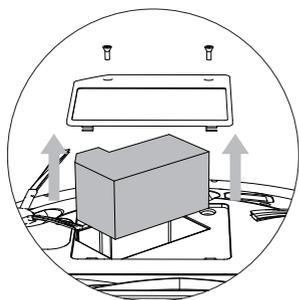
1. Открутите два винта на крышке батарейного отсека, затем снимите крышку и батарею.
