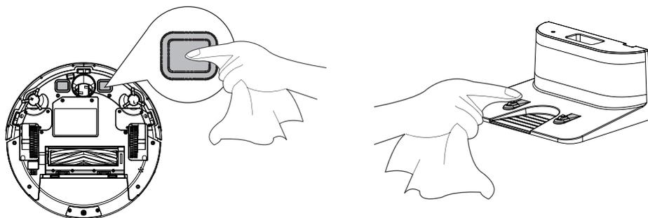
2. Протрите зарядные контакты на роботе и базе для подзарядки чистой сухой тканью.
