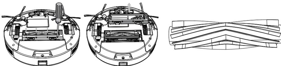
1. Чтобы вынуть винт, снимите раму щётки и прочие элементы, используя монету или небольшую отвертку.
