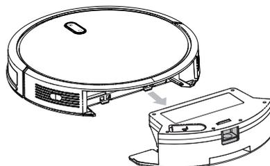
3. Вставьте заполненный резервуар для воды в робот-пылесос.
