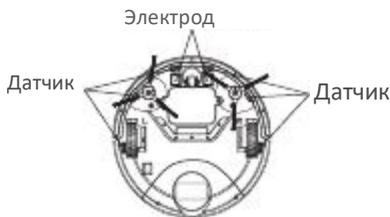
Б. С помощью чистящего приспособления или мягкой тряпки аккуратно протрите разъем для зарядки. См. точку, показанную на схеме ниже:
