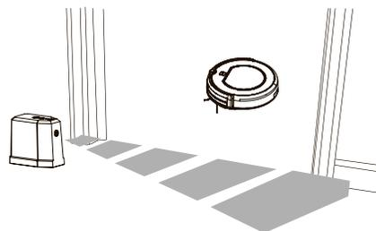
К данной модели робота-пылесоса можно дополнительно приобрести «виртуальную стену».
