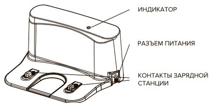
Используется роботом-пылесосом в качестве зарядной базы при завершении уборки или в случае низкого заряда аккумулятора. Робот самостоятельно обнаруживает станцию, реагируя на инфракрасный сигнал базы.
