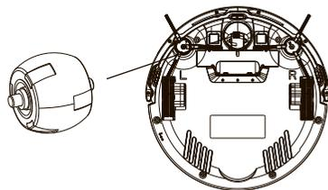
Извлеките переднее колесо из держателя, поддев его плоской отверткой с боков. Тщательно очистите полость под колесом, само колесо, его металлическую ось, а также датчики, расположенные в пазу для крепления модуля переднего колеса. Затем установите переднее колесо обратно, убедившись, что оно плотно закреплено держателем.
