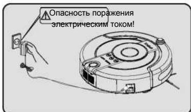
1. Зарядка прибора с использованием адаптера: Подсоедините адаптер к пылесосу, затем вставьте вилку адаптера в розетку.
