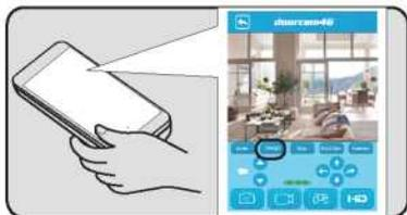
1. Управление процессом зарядки со смартфона: Установите приложение, откройте интерфейс управления, нажмите кнопку «charge» (зарядка), пылесос приступит к поиску зарядной станции.
