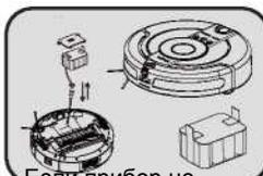
Если прибор не используется долгое время, полностью зарядите батарею, затем извлеките ее из прибора и положите в темное место. Днище пылесоса вытрите насухо.
