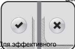
Для эффективного функционирования следует устанавливать зарядную станцию и ограничитель движения «Виртуальная стена» около стены на ровной плоской поверхности.
