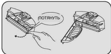
1. Вытяните пылесборник, затем нажмите фиксаторы с двух сторон и откройте лоток.
