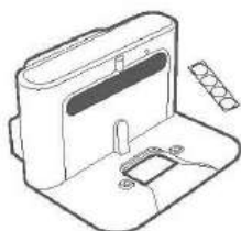
Зарядная станция и лента для крепления к полу
