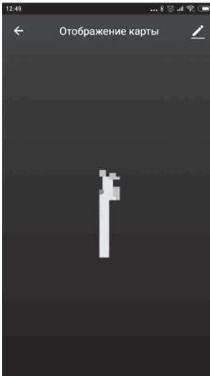
Служит для просмотра карты уборки помещения. Робот рисует карту, чтобы не убирать повторно одни и те же места. При включении/выключении пылесоса, при переходе в другие режимы или в режим ожидания карта помещения сбрасывается и при следующей уборке рисуется заново.
